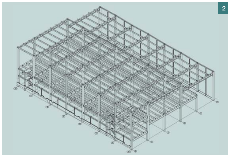
Obr. 1 Celkový model 3D objektu haly 2A lakovna ■ Fig. 1 3D visualisation of the building hall 2A paintshop
